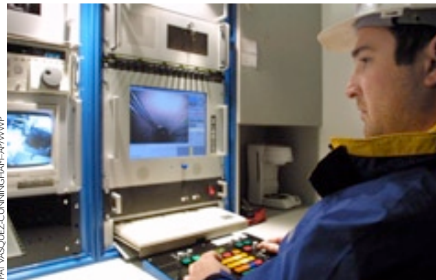
Observant en temps réel une vidéo prise à l'intérieur d'un égout, le technicien Jeremy Vanrite manœuvre un Robot SAM (Sewer Access Module) qui arpente les égouts d'Albuquerque (Nouveau-Mexique), grâce à des contrôles informatisés interactifs.
