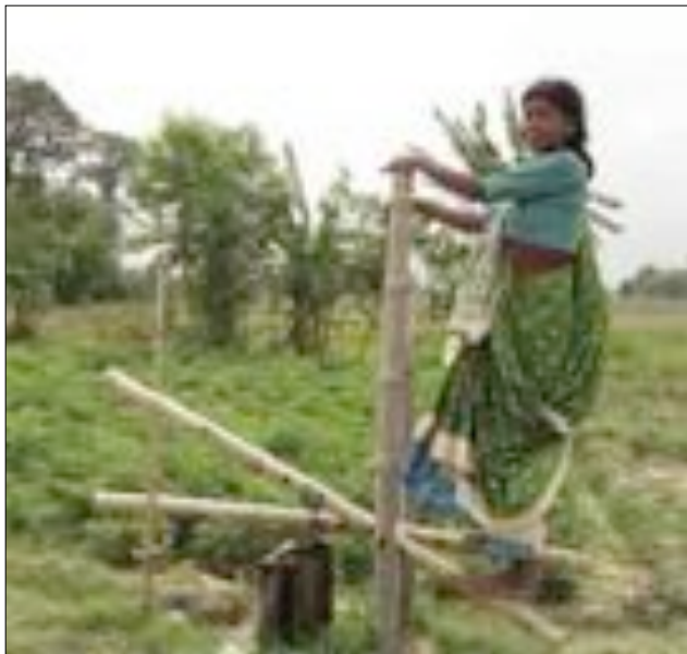
Une Népalaise fait fonctionner une pompe à pédale en bambou.
