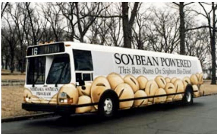
Ce bus roule grâce à un carburant diesel à base de soja.
